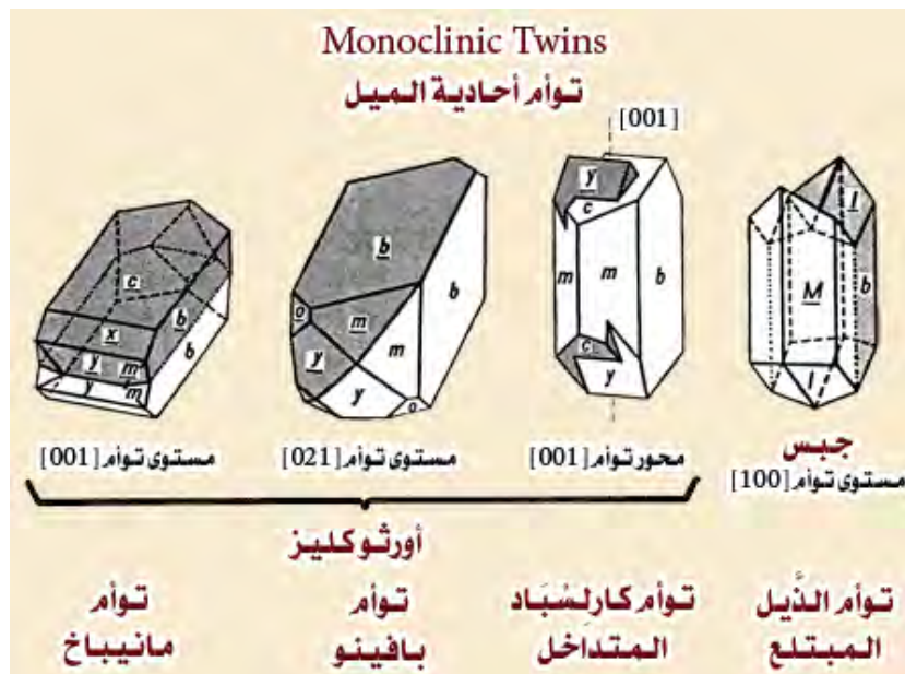
شكل T.106g توائم أحادية الميل، أمثلة لقانون توائم شائع في بلورات أحادية الميل Klein & Hurlbut, 1993.
